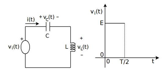
El circuito de la figura de la izquierda se encuentra inicialmente en reposo. Se aplica la tensión  $v_i(t)$  de la figura de la derecha, con  $T=2\pi\sqrt{LC}$ , que consiste en una tensión constante de valor E durante los primeros T/2 segundos, que luego se anula. Se introduce la pulsación  $\omega_0=\frac{2\pi}{T}=\frac{1}{\sqrt{LC}}$ .
