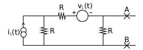
Explicar qué es el equivalente de Thévenin y hallarlo para este circuito entre los puntos A y B, en función de R,  $v_1(t)$  e  $i_1(t)$ . Explicar claramente cómo procede.
