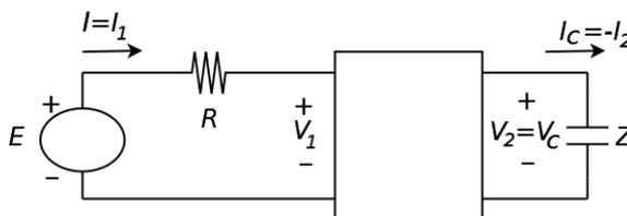
Por lo anterior, podemos considerar un circuito equivalente que sea simplemente la fuente sinusoidal alimentando la serie de  $R$  con la impedancia opuesta a la del condensador  $Z_c = \frac{1}{Cj\omega}$ , con  $\omega = 100\pi$ . Entonces, la impedancia que ve la fuente en régimen sinusoidal vale  $Z_{eq} = R - \frac{1}{Cj\omega} = R + j\frac{1}{C\omega} = R + jX$ , que es inductiva, pues su reactancia  $X$  es positiva. Trabajamos en valores eficaces.
