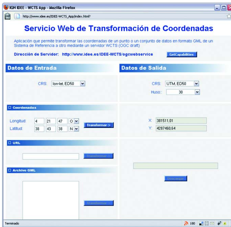
Figura 40. Transformación de un punto con el servicio de transformación de coordenadas de la IDEE
