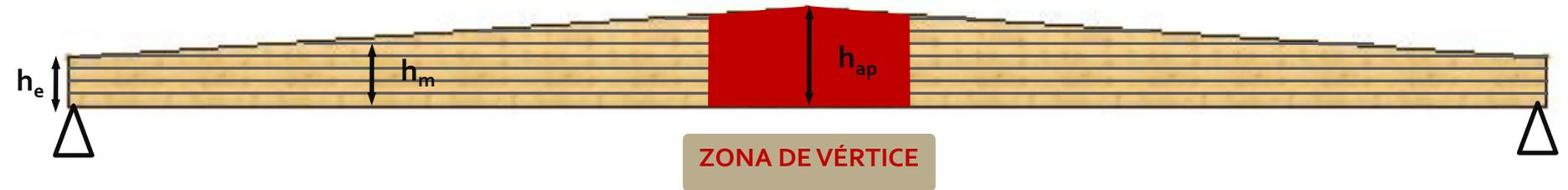
Volumen de madera correspondiente a la zona localizada en el cambio de pendiente de la pieza, de anchura =  $h_{ap}$ .
