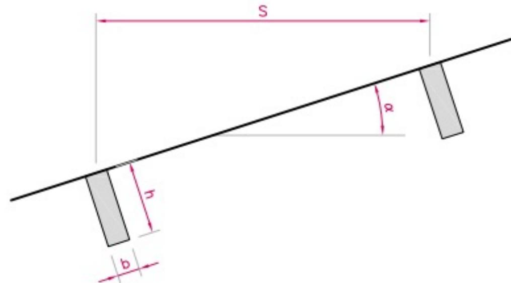
Las correas soportan una carga permanente lineal (de peso propio y de los elementos constructivos) de 1.0 kN/m (con coeficientes parciales de seguridad  $\gamma_F = 0.80$  y  $\gamma_F = 1.35$ ). Además, la cubierta resiste una sobrecarga de uso puntual (de duración corta) de 3.6 kN, y una carga de viento (de duración instantánea) que tiene asociada una presión de pico de 1300 Pa y coeficientes totales de presión 0.31 y - 1.03.
