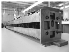
Figura : Intercambiador con PCM (DISTOR project).
