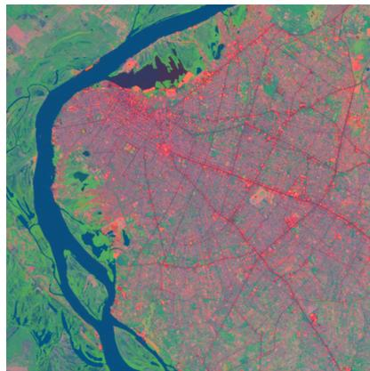
(b) Imagen de Asunción de seis bandas luego de aplicado el algoritmo de PCA.
