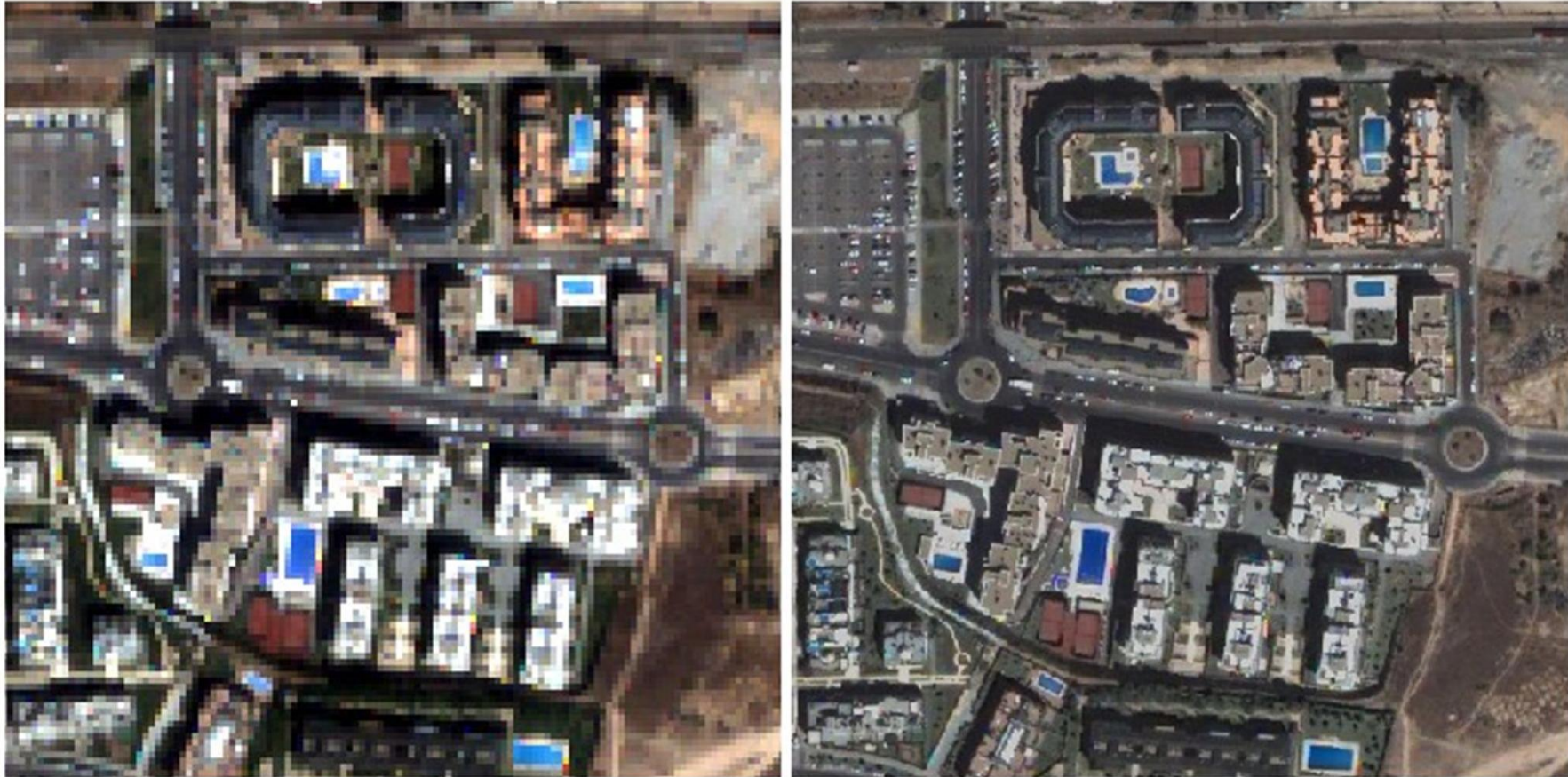
Imagen multispectral original (izda) comparada con la imagen fusionada mediante FIHS.
