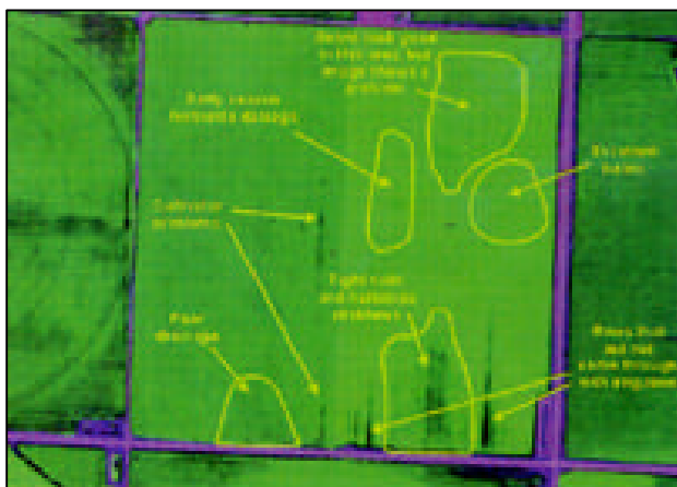
Imagen compuesta por la combinación de longitudes de onda en un índice de salud relativa, en un lote sembrado con maíz (izquierda) y soja (derecha). Note la relativa facilidad para detectar áreas con variabilidad debido al esquema de colores utilizado.
