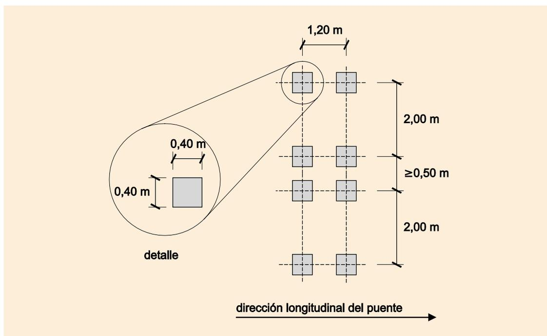
FIGURA 4.1-c DISPOSICIÓN DE VEHÍCULOS PESADOS PARA COMPROBACIONES LOCALES
