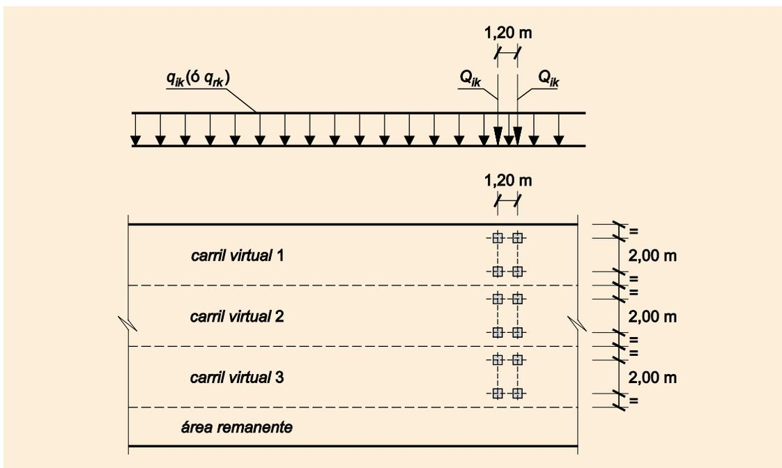
FIGURA 4.1-b DISTRIBUCIÓN DE VEHÍCULOS PESADOS Y SOBRECARGA UNIFORME
