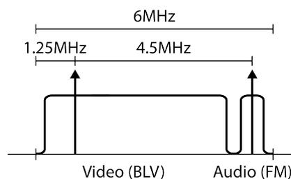
La señal de audio tiene un ancho de 15 kHz y se modula en FM, con  $f_{\Delta} = 25$  kHz. Las frecuencias portadoras de la señal de audio y video están separadas 4.5 MHz. La relación de potencia de transmisión de la señal de video y audio es 10:1. El receptor introduce ruido AWGN de densidad espectral de potencia  $\frac{\eta}{2}$  con  $\eta = 10^{-14}$  Watt/Hz.
