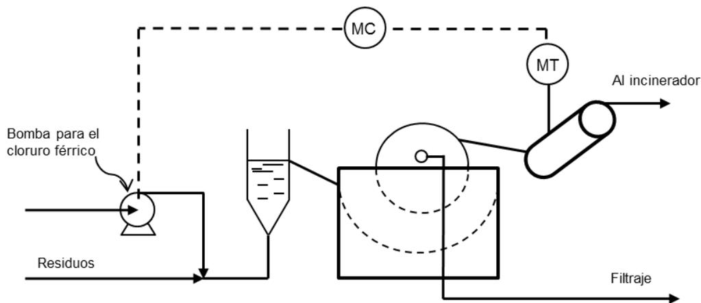
Los siguientes datos se obtuvieron con una prueba de escalón sobre la salida del controlador (MC) de + 2 mA:
