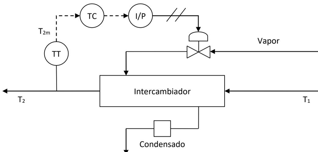
Durante una prueba con bucle abierto la presión de vapor  $P_s$  se cambia bruscamente de 18 a 20 psig, y se obtiene la siguiente tabla de temperaturas.
