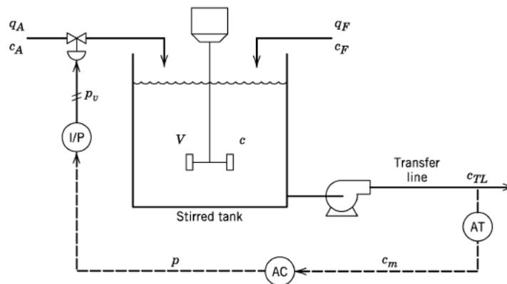
Como la concentración de la corriente A suele variar se implementa el sistema de control que se muestra en la figura.
