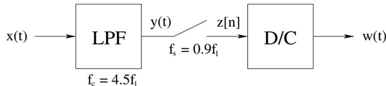
donde  $x(t)$  es una señal periódica de período  $T_1 = 1/f_1$ ;  $f_c$  es la frecuencia de corte del filtro pasabajos;  $f_s$  es la frecuencia de muestreo; y el bloque D/C es un reconstructor ideal. Se asumirá, para simplificar, que no hay ruido sumado a la señal.
