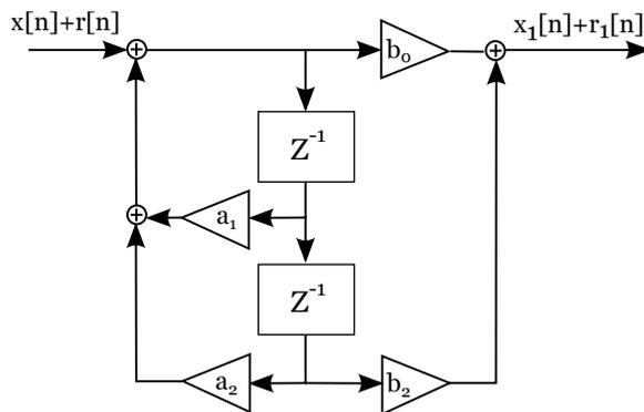
(g) Hay dos fuentes de error en la entrada al filtro y dos fuentes de error en la salida.
