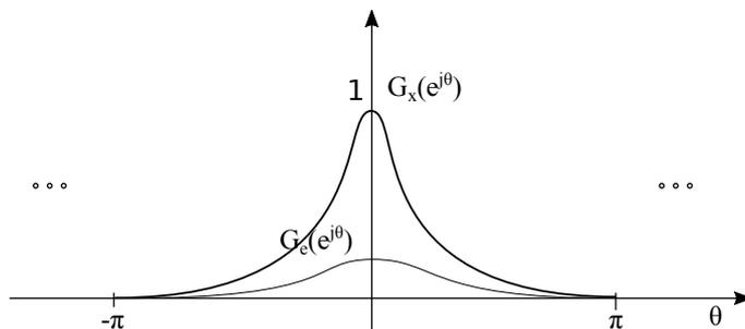
La potencia del ruido se puede calcular aplicando Parseval para el caso en que la entrada a un sistema tiene características de ruido blanco, siendo  $P_e = \sigma_e^2(0.5^2 + 2 * 0.25^2) = 0.375 \times 5.086 \times 10^{-6} = 1.907 \times 10^{-6}$
