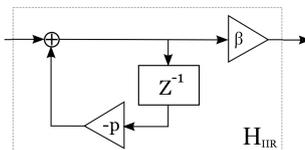
(h) Hay una única fuente de error en las operaciones para el filtro  $H_{FIR}$  mientras que hay dos en el filtro  $H_{IIR}$ .
