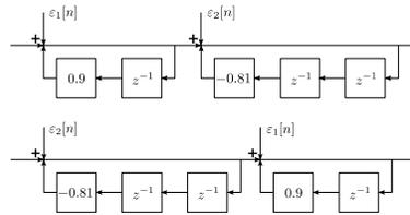
Llamando  $\sigma_e^2$  a la potencia de cada uno de los errores, la potencia de los errores a la salida será, para el caso  $H_1 \rightarrow H_2$ ,
