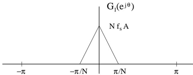
Al cuantizar se suma el ruido de cuantización, de densidad espectral de potencia constante y altura  $\frac{\Delta^2}{12} = 2^{-2b}/3$ .
