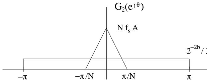
El filtro anterior al decimador debe tener frecuencia de corte  $\theta_c = \pi/N$  para evitar el solapamiento y ganancia 1. Luego del filtro y antes del decimador tenemos:
