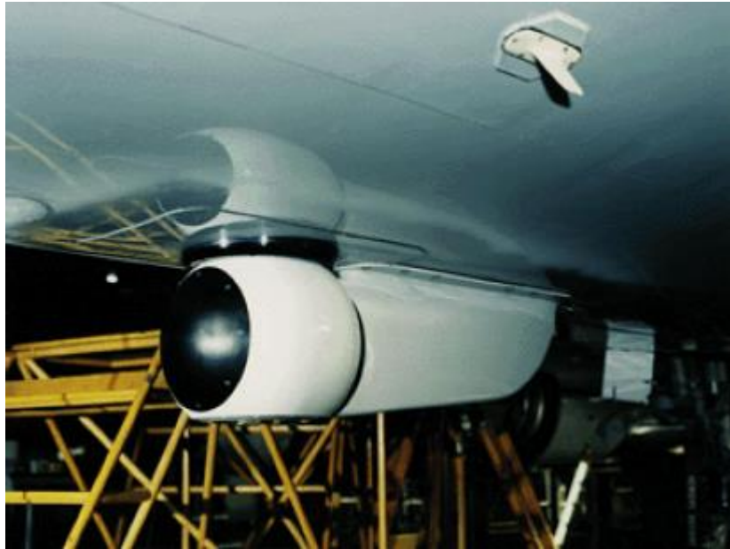
Imagen 3: Sensor LIDAR montado en un avión
