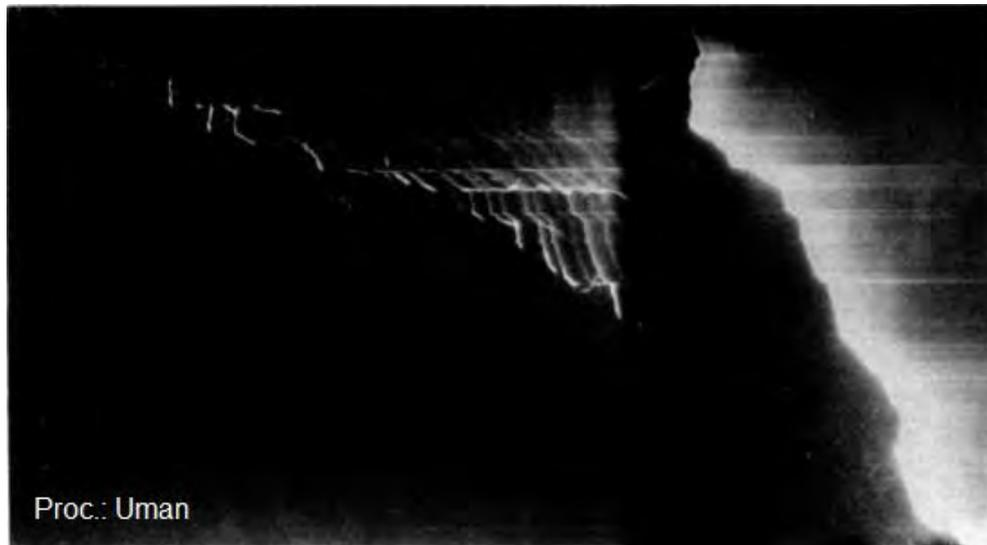
Figura 3.5: La guía escalonada y su descarga de retorno.
