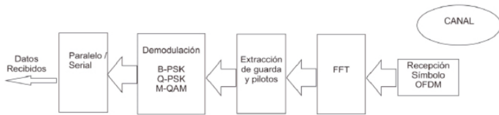
Figura F.1: Bloques demodulador OFMD ( http://www.scielo.org.mx/ ).
