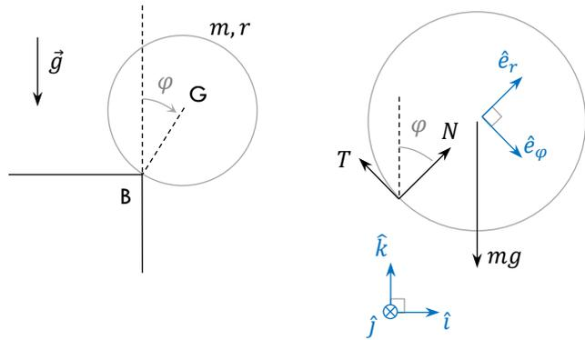
(a) Se asume que no hay deslizamiento. El punto de contacto del disco con el punto B de la superficie tiene velocidad nula, y el disco realiza una rotación pura alrededor de B.
