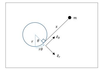
b) La tensión de la cuerda tiene la dirección del hilo. Proyectamos la segunda ley de Newton en la dirección perpendicular (o sea, según  $\hat{e}_r$ ) y obtenemos la ec. de movimiento:
