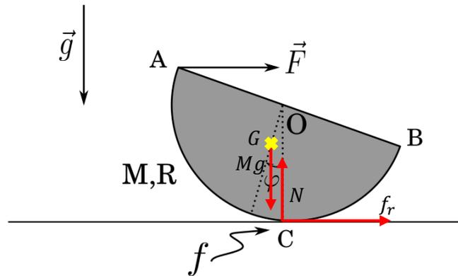
Tenemos que vincular la aceleración angular del disco ( $\ddot{\phi}$ ) con la aceleración del centro de masa ( $\vec{a}_G$ ).
