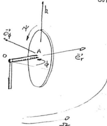
$$\vec{\omega}_o = \mathbb{I}_o \vec{\omega} = \frac{ma^2}{4} (-2\dot{\gamma} \vec{e}_r + 5\dot{\phi} \vec{k})$$
