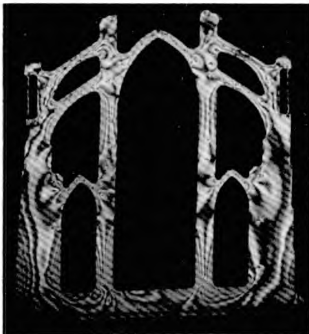
Figura 8 Una pieza de plástico vista entre láminas polarizadoras cruzadas. Los patrones de claros y oscuros muestran las regiones de esfuerzo en la estructura.
