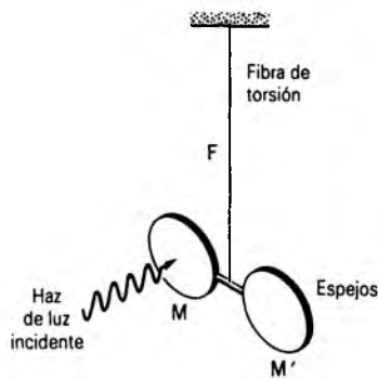
Figura 13 El dispositivo de Nichols y Hull para medir la presión de radiación. En el dibujo se han omitido muchos detalles de este delicado experimento.
