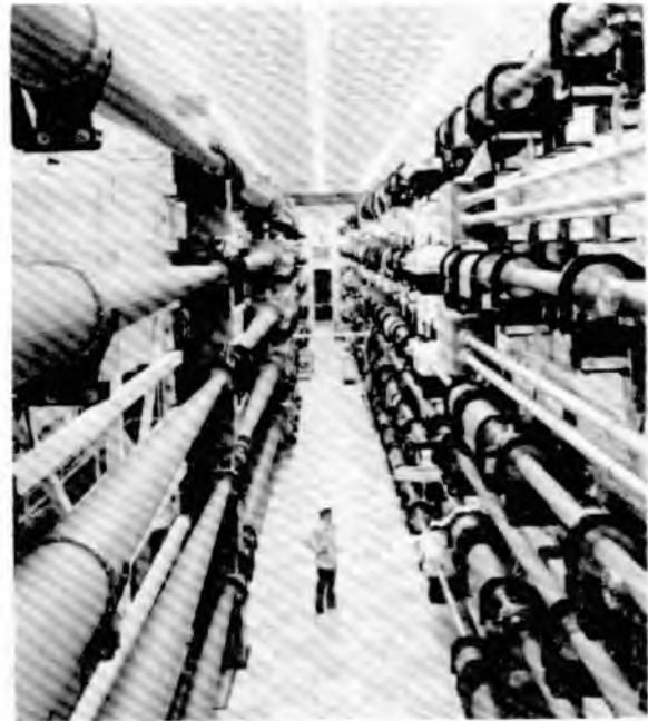
Figura 9 La sala del láser NOVA en el Lawrence Livermore National Laboratory. Estos láseres, con una potencia de unos 10^{14} W, se emplean para la investigación de la fusión termonuclear controlada (véase la Sec. 55-10).
