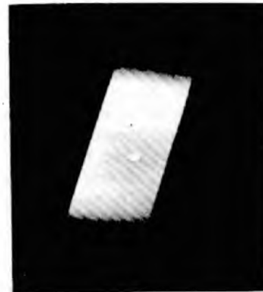
Figura 2 Un tubo incandescente de tungsteno con un pequeño orificio taladrado en su pared. La radiación que emerge del orificio es la radiación de la cavidad.
