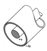
**Ejercicio 4** Un conductor aislado de forma arbitraria contiene una carga neta de  $+10\mu C$ . Dentro del conductor hay una cavidad hueca en la cual hay una carga puntual  $q = +3.0\mu C$ . Cuál es la carga (a) en la pared de la cavidad y (b) en la superficie externa del conductor?
