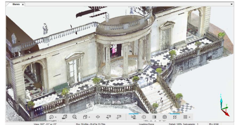
Imágen 36: Perspectiva de nube de puntos con TX5 - SCENE (Fuente propia)
