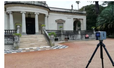
Imágen 14: Escaner TX5 instalado en fachada frontal (Fuente propia)
