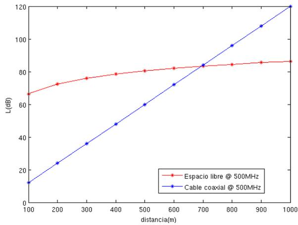
(b) A 100m y frecuencia 500 MHz:  $L_{EL} = 66.4$  y  $L_{coax} = 12$ .
