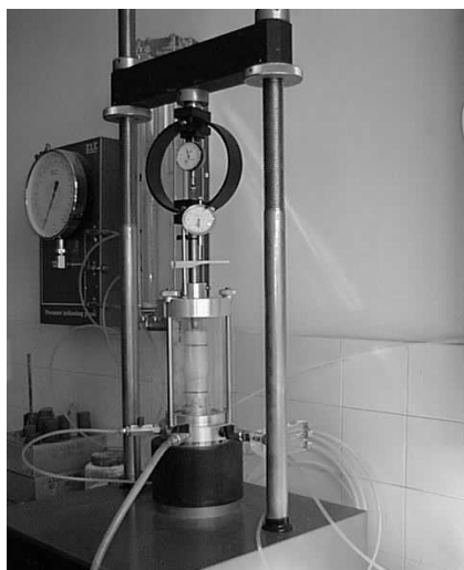
Foto 1. Triaxial utilizado en la investigación para la ejecución de ensayos de compresión axial inconfinada
