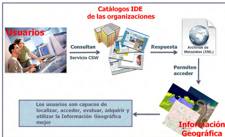
FIG. 11.1. El catálogo de una IDE permite acceder a la IG a través de servicio CSW. (Fuente: Elaboración propia)
