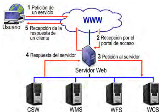
FIGURA 2.2. Esquema de peticiones del modelo cliente-servidor. (Fuente: Elaboración propia)
