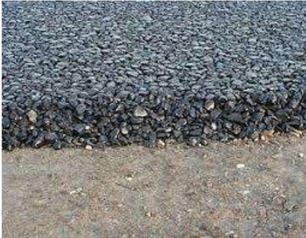
Material conformado por agregados ligados por cemento asfáltico
