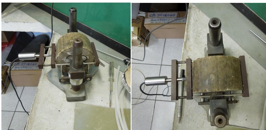
Figura 3.11. Sistema de leitura externa de deslocamento horizontal do ensaio de fadiga
