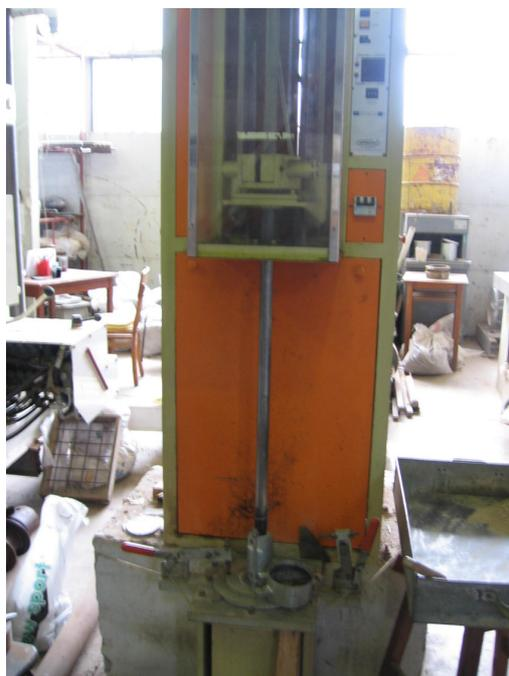
Figura 3.6. Compactador mecânico da *Sección Geotécnica* da UdelaR
