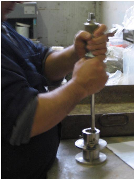
Figura 3.7. Sistema de compactação Mini-Harvard
