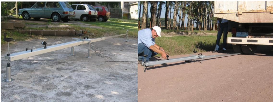
Figura 3.8. Levantamentos deflectométricos com Viga Benkelman
