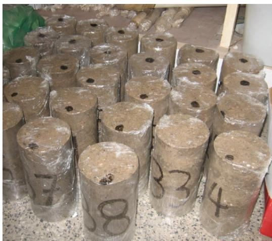
Figura 3.21. Cura de corpos-de-prova em câmara úmida
