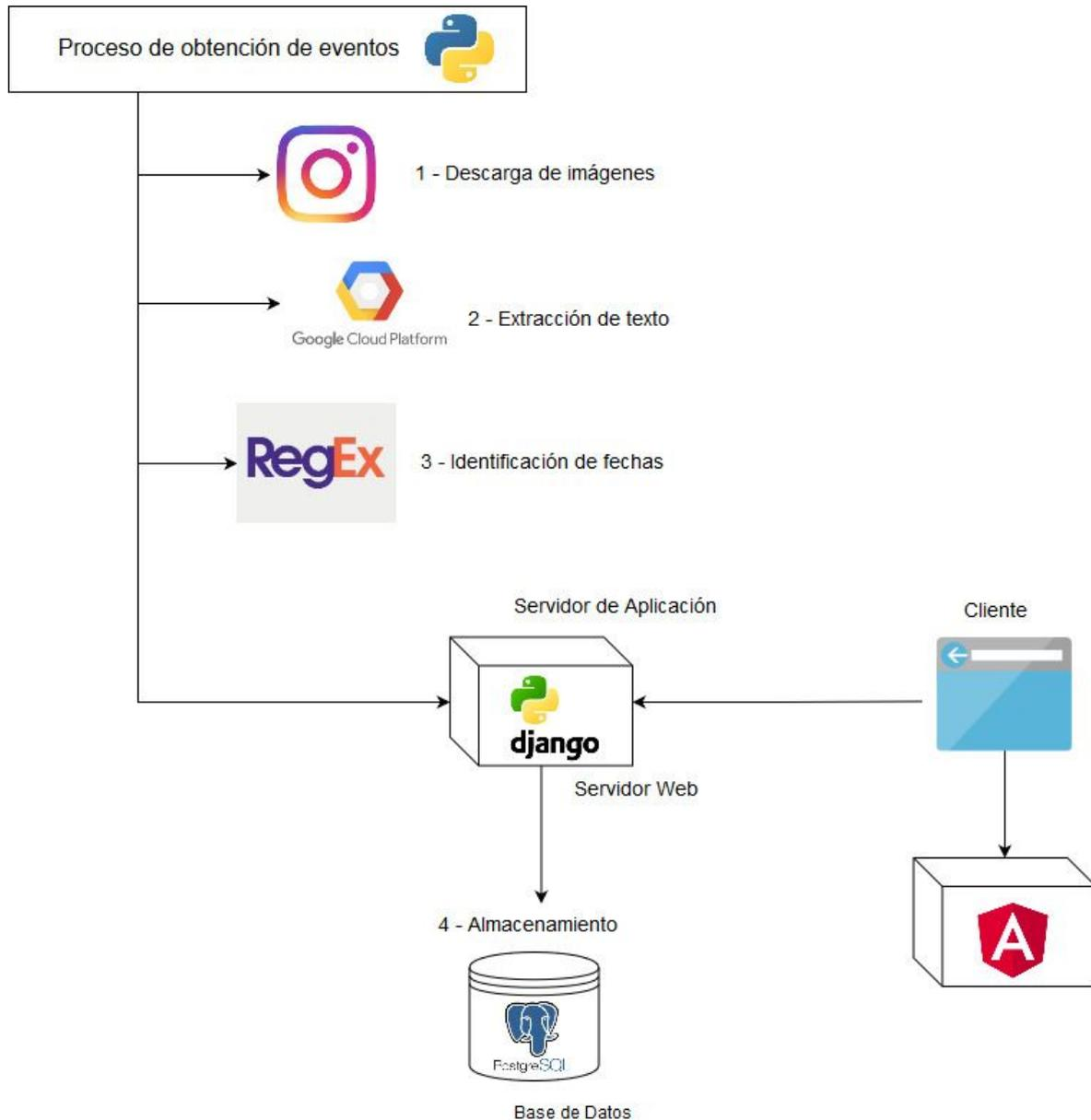
El usuario mediante una aplicación web pública desarrollada en Angular consume una API Rest desarrollada en Python con el framework Django, la cual provee los datos almacenados en una base PostgreSQL en ambiente dockerizado. El último elemento a destacar es el módulo python de creación de eventos, cuya lógica obtiene las imágenes, extrae el texto e identifica las fechas y por medio de la api ofrecida por django almacena en la base de datos la información obtenida.
