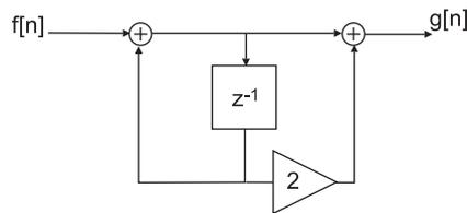
(d) El sistema tiene un polo en  $z = 1$  y un cero en  $z = -2$ . Como es un sistema causal, la región de convergencia corresponde a  $|z| > 1$ .
