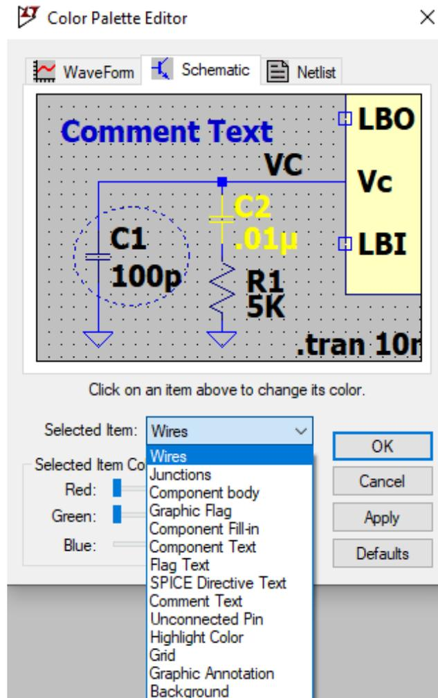
De esta manera, se puede cambiar el color de los cables (“Wires”), de los puntos que unen varios cables (“Junctions”), de los componentes (“Component body”), y lo demás, incluyendo la grilla (“Grid”) y el fondo (“background”).
