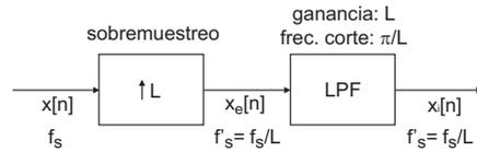
El filtro pasabajos interpola entre las muestras no nulas de  $x_e[n]$ , generando la señal sobremuestreada  $x_i[n]$ . Cuando el pasabajos es ideal, la interpolación lleva el nombre de interpolación de banda limitada. Dos interpoladores comúnmente utilizados (por su simplicidad) son el interpolador lineal y el bloqueador de orden cero. En la interpolación del bloqueador de orden cero, cada valor de  $x[n]$  se repite  $L$  veces, i.e.,
