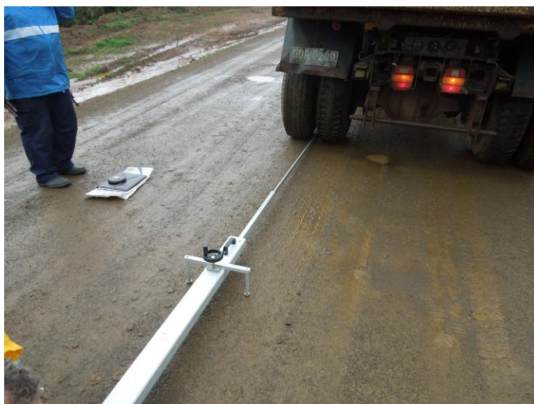
Figura 5.15. Marcas Dejadas por el Neumático del Camión en la Superficie del Pavimento en Condiciones Húmedas.
