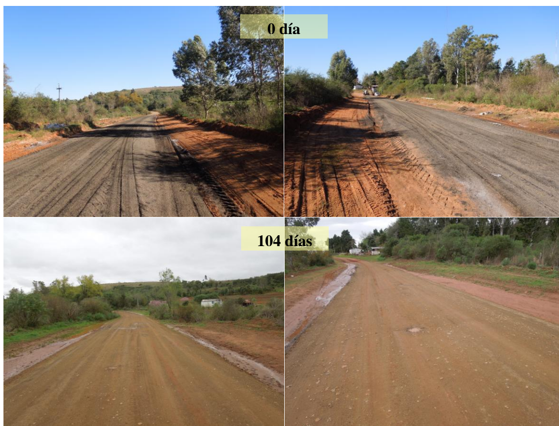
Figura 5.14. Condición Funcional del Tramo Experimental Unicapa del Camino a la Piedra Pintada Inmediatamente Después y a 104 Días de su Construcción
