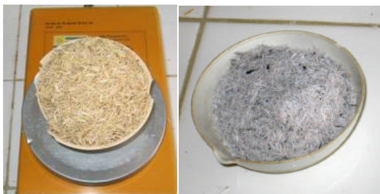
Figura 5. 1 - Casca de arroz e da cinza de casca de arroz antes e depois da incineração na mufla. Esquerda: casca de arroz. Direita: cinza de casca de arroz.
