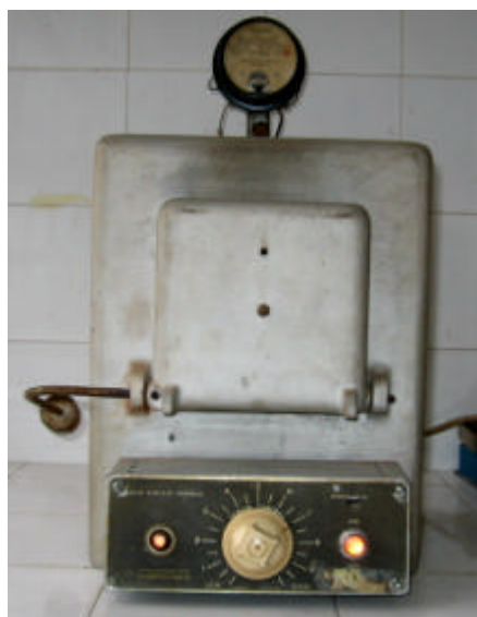
Figura 3. 1 - Mufla para a incineração da casca de arroz a temperaturas controladas.
