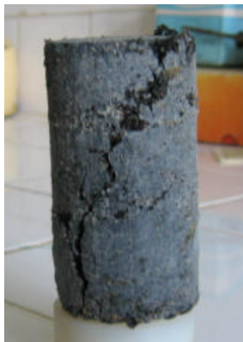
Figura 4. 24 – Ruptura frágil apresentada na amostra submetida a ciclos de molhagem e secagem.
