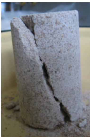
Figura 5. 12 – Ruptura frágil do corpo-de-prova da mistura solo-15% CCA TC650 -5% Cal submetido à compressão simples.
