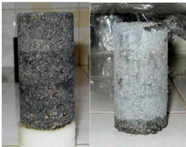
Figura 4. 23 – Estado das amostras imediatamente antes de ser ensaiadas. Esquerda: amostra não submetida a ciclos. Direita: amostra submetida a ciclos.
