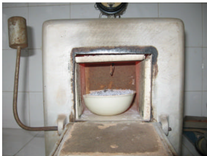
Figura 3. 2 - Vista da mufla durante a incineração da casca de arroz.
