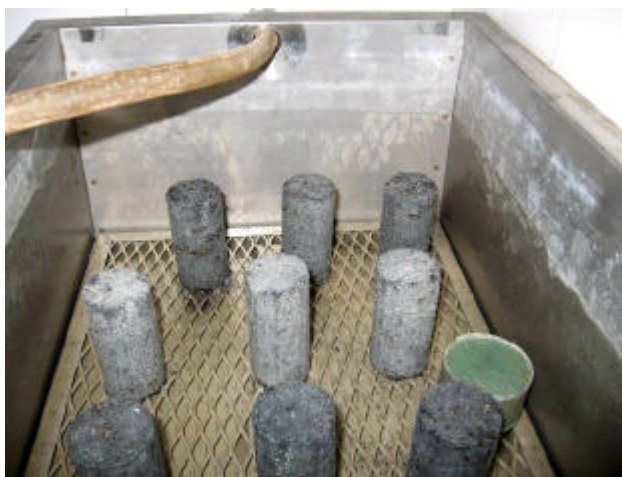
Figura 3. 4 - Dispositivo para processar os ciclos de molhagem e secagem do ensaio de durabilidade. Observam-se os corpos-de-prova.
