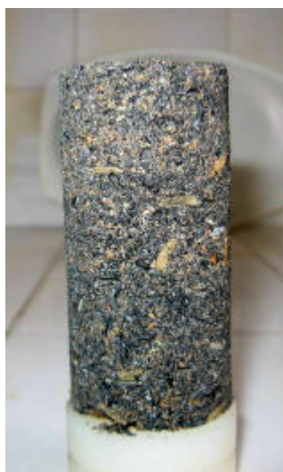
Figura 4. 13 – Corpo-de-prova de mistura solo-CCAr-cal para o ensaio de resistência à compressão simples.
