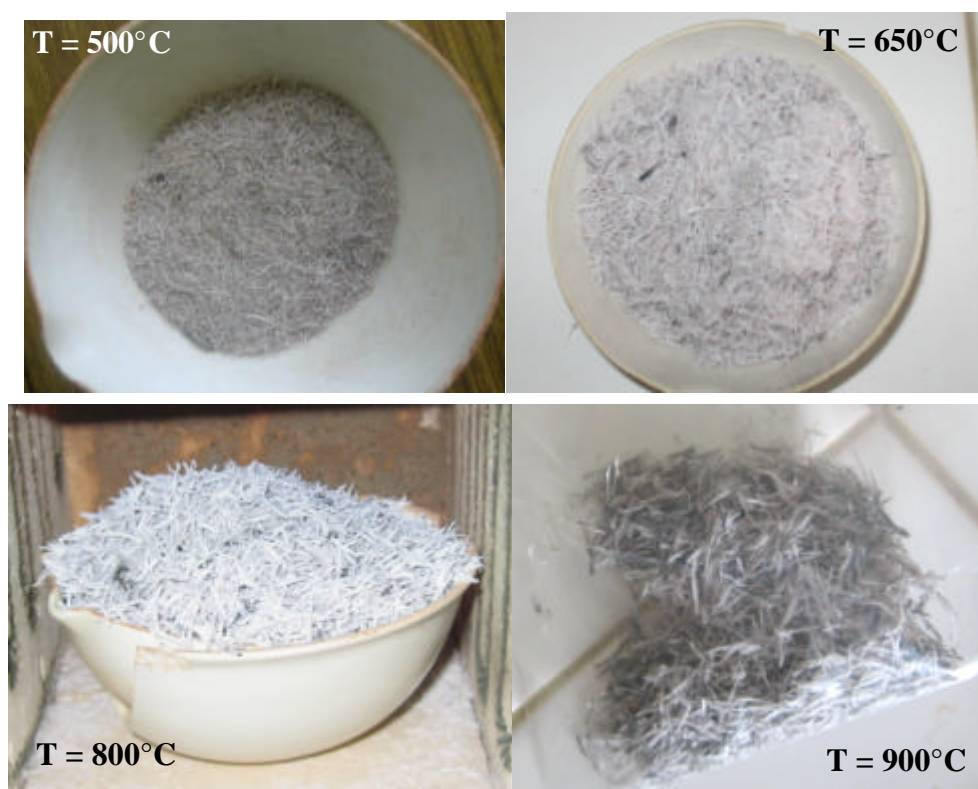
Figura 5. 3 – Aparências das cinzas incineradas a diferentes temperaturas controladas. Acima à esquerda: CCA à temperatura de 500°C. Acima à direita: CCA à temperatura de 650°C. Abaixo à esquerda: CCA à temperatura de 800°C. Abaixo à direita: CCA à temperatura de 900°C.
