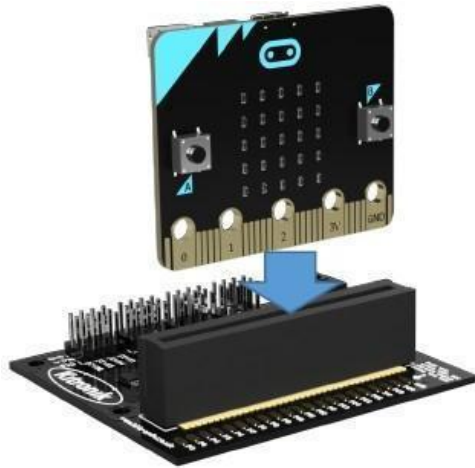
Figura 5: Conexión Micro Bit-Servo Driver
