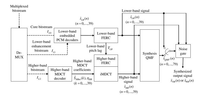
La codificación resultante puede operar en 4 modos, según se muestra en la tabla siguiente, generando tasas de bits de 64,80 o 96 kb/s. En el caso de la trama R2, no se provee información acerca de si contiene información de mejoras de la banda baja o de la banda alta, por lo que esto debe ser especificado en forma explícita al decoder.
