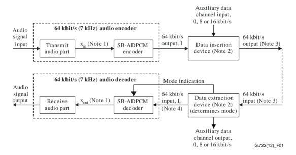
El componente inicial es un digitalizador lineal, de 14 bits y 16 kHz, tal como se muestra en la siguiente figura
