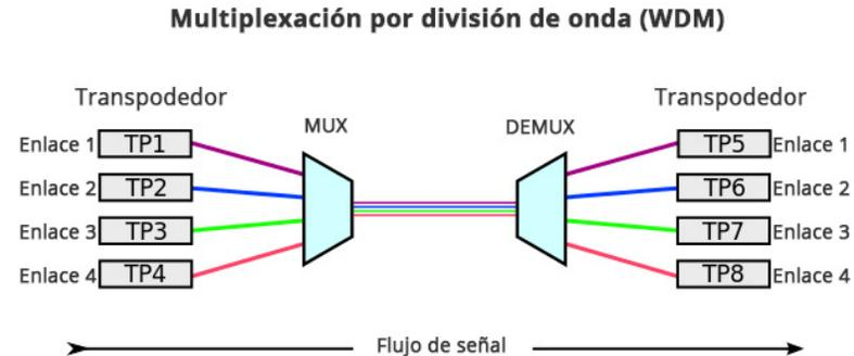
Esta tecnología emplea múltiples longitudes de onda (“lambda”) para transmitir diferentes flujos de datos sobre una misma fibra óptica.
