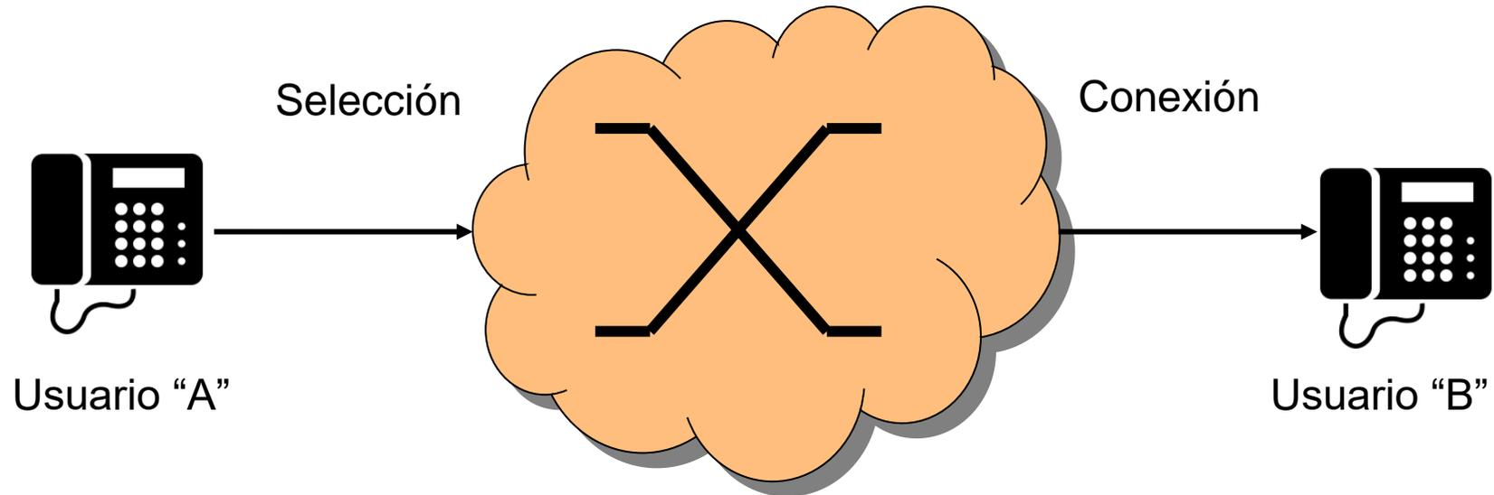
Es el proceso para establecer una conexión individual desde un punto de entrada (nodo "A"), hacia un punto de salida (nodo "B")
