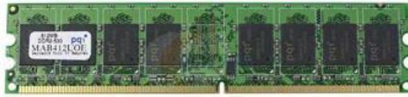
Los módulos DDR3 también utilizan 240 contactos, aunque como son incompatibles eléctricamente, tiene la "mueca" de identificación (cortes en forma de "media luna" que poseen en ambos extremos y en el medio) en otro lugar para evitar confusiones, mientras que los DDR4 utilizan 288 contactos.
