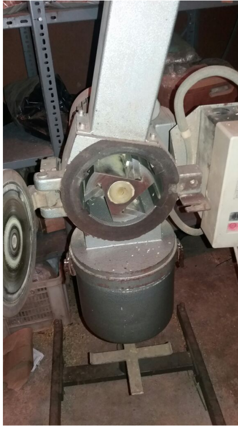
Figura 3.2: Molino Retsch Mühle , 2,2 kW.
