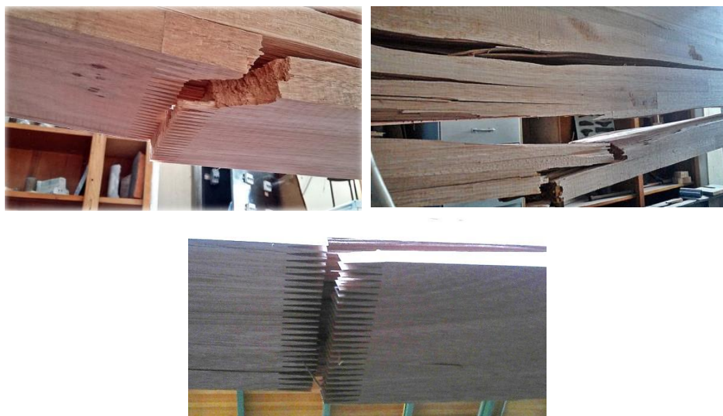
Figura 5.3: A la izquierda-arriba rotura mixta, a la derecha-arriba rotura por madera y abajo rotura por adhesivo.
