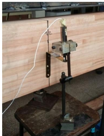
Figura 4.21: LVDT utilizado para la medición del desplazamiento de las fibras en la sección media de las vigas.
