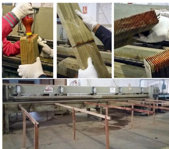
Figura 4.8: Muestra de la instancia anterior y posterior a la aplicación de presión sobre la unión dentada.
