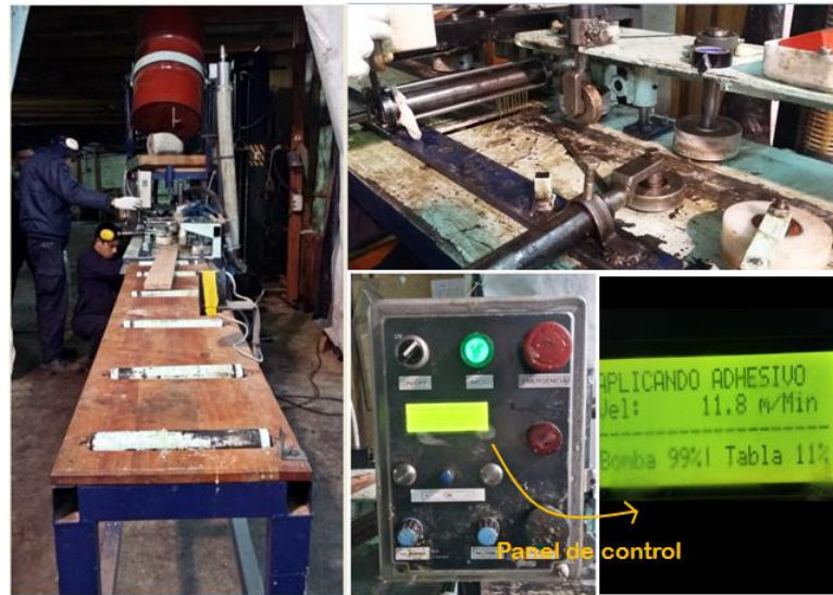
Figura 4.12: Encolado de las láminas
