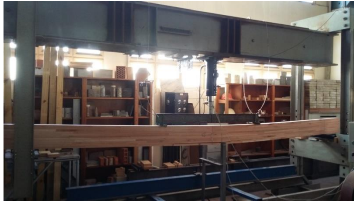
Figura 4.20: Banco de ensayos utilizado para ensayo a flexión de vigas.
