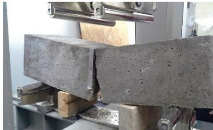
**Figura 75:** Rotura brusca en el ensayo de flexión.
