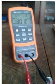
**Figura 45:** Medidor de impedancias LCR.
