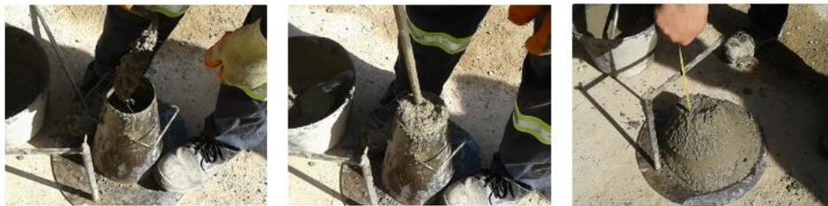
**Figura 15:** Proceso del ensayo del cono de Abrams.
