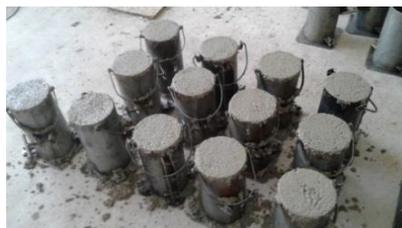
**Figura 16:** Probetas cilíndricas.
