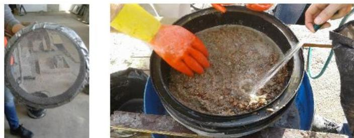
**Figura 19:** Proceso de filtrado de fibras.
