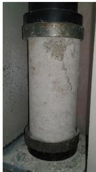
**Figura 20:** Ensayo a compresión a los 3 días de edad.
