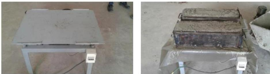
**Figura 18:** Mesa vibratoria con probetas prismáticas.
