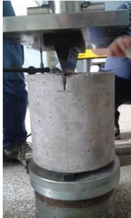
**Figura 79:** Ensayo MVD sobre probeta cilíndrica.
