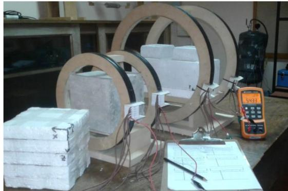
**Figura 47:** Bobina D22 (con probeta cúbica de HRFA) y bobina D40 (con bloque ASSEMBLOCK de CP reforzado con fibras).
