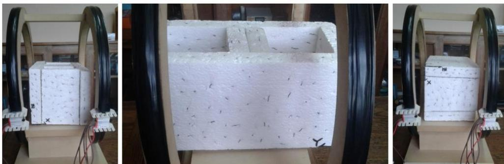
**Figura 48:** Bloque ASSEMBLOCK de espuma plast ensayado en las tres direcciones.
