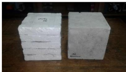
**Figura 36:** Cubo patrón (izquierda) y cubo de HRFA (derecha).
