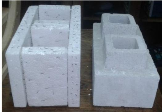
**Figura 42:** Bloque patrón y bloque ASSEMBLOCK de CP reforzado con fibras.
