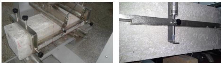
**Figura 21:** Configuración para el ensayo de tracción.
