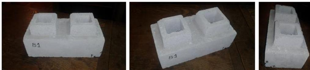
**Figura 38:** Bloque ASSEMBLOCK de CP reforzado con fibras de acero.
