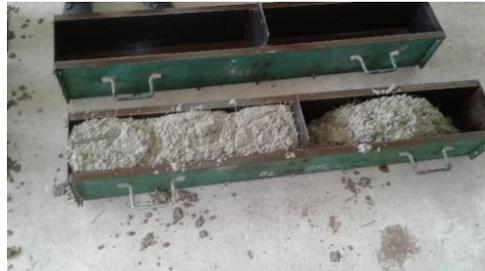
**Figura 17:** Llenado de probetas prismáticas.
