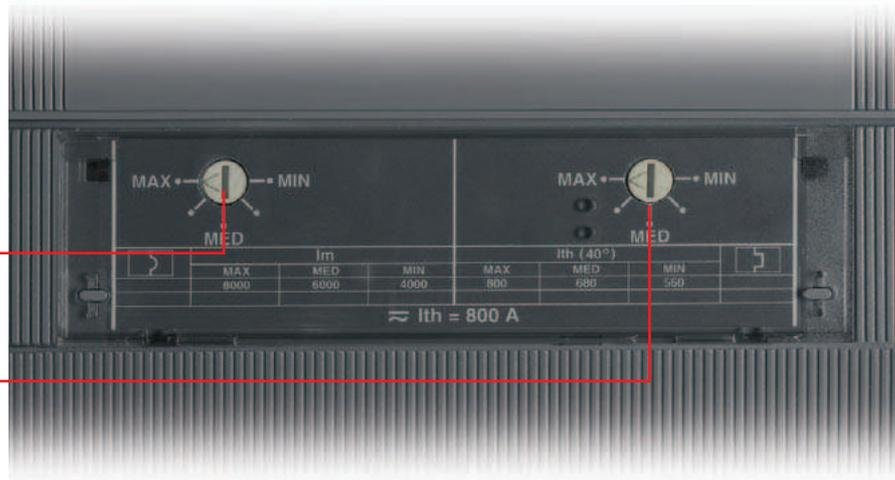
TMA = relé termomagnético con umbral térmico regulable ( $I_1 = 0,7...1 \times I_n$ ) y umbral magnético regulable ( $I_3 = 5...10 \times I_n$ )
