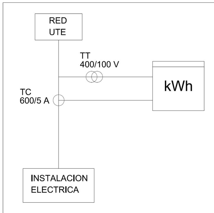
ii) Medidas de corriente y tensión de línea promedio en los conductores de entrada al tablero general de la instalación:
