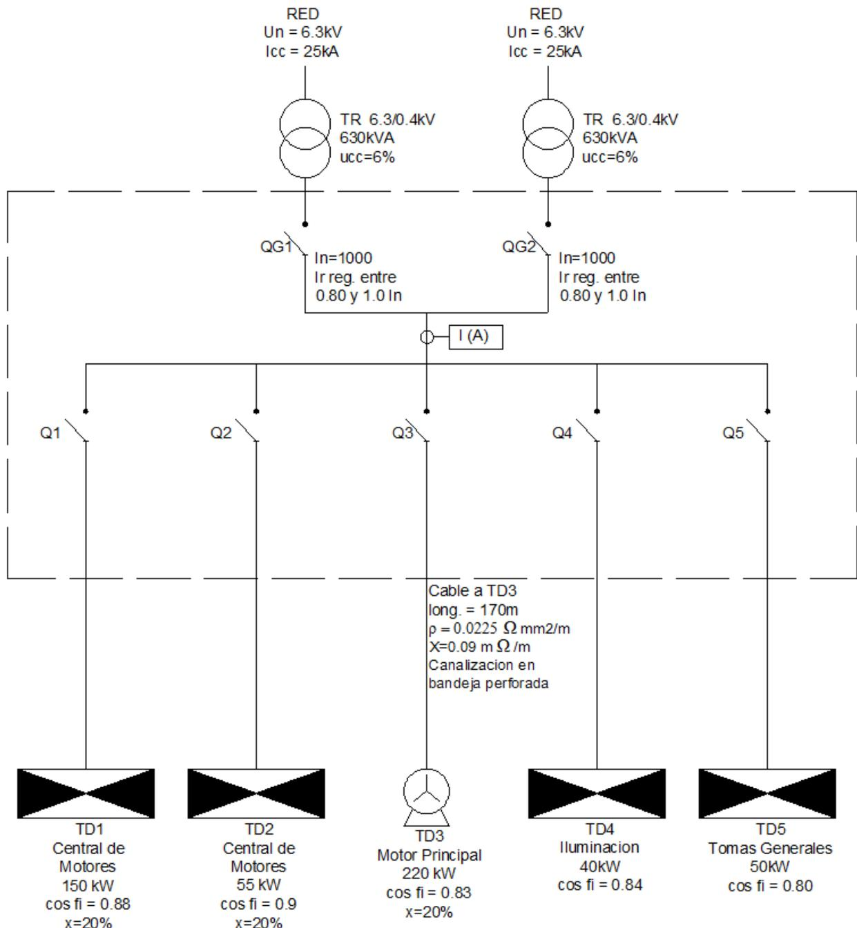
Los transformadores trabajan en paralelo, por lo que QG1 y QG2 están simultáneamente cerrados. Los Tableros TD1, TD2 alimentan a cuadros de motores y TD3 alimenta al motor principal de la planta, el Tablero TD4 Iluminación y el Tablero TD5 Servicios Generales. Las potencias indicadas son las potencias máximas demandas por cada carga. El Tablero General cuenta con un medidor de corriente total cuyo registro de demanda máxima es de  $I=750A$ .
