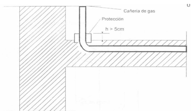
Cañería en contrapiso
