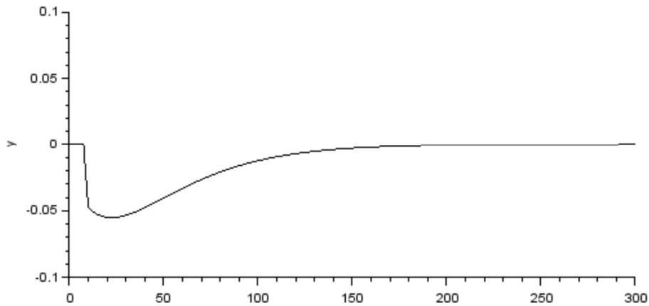
b) El control dinámico (lead-lag):  $G_{ffc}(s) = -\frac{0,5(25s+1)e^{-2,5s}}{0,4(30s+1)}$  psig / unidades de pH
